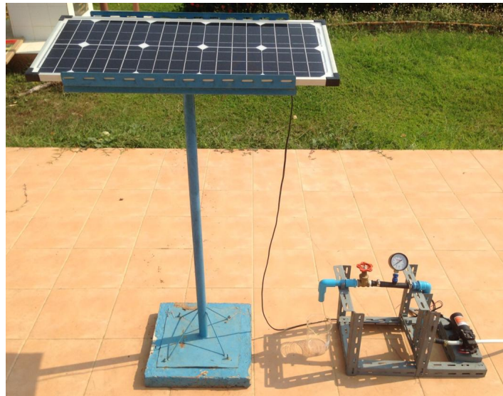
ภาพที่ 1 เครื่องสูบน้ำพลังงานแสงอาทิตย์ต้นแบบ สำหรับชุมชน ต. จอมทอง
